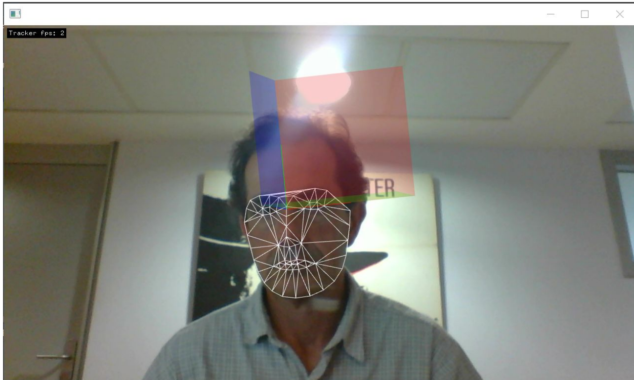
Imagen 1 - Ejemplo de cálculo de la malla definida por el resto del sujeto, donde se muestran tanto la malla, como los ejes que definen la orientación. En este caso el plano normal, que se analizaría sería el mostrado en azul.
